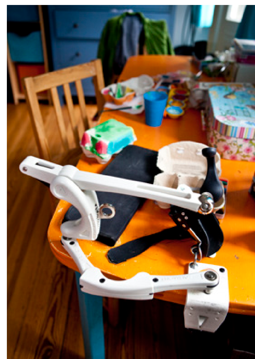
Die dynamische Armschiene verstärkt kleinste Bewegungsimpulse und ermöglicht z. B. selbständiges Essen trotz einer Lähmung der Arme – so kommt die Stulle zum Mund.
